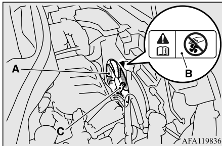
A- Cooling fan
